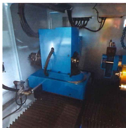
NC旋回主軸台 Work head axis NC turning specification (コレットチャック装着用 Collet chuck)
