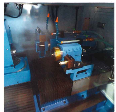
砥石台部 Wheel Head (外径用砥石 wheels diameter 150dia 内径用高周波スピンドル)
