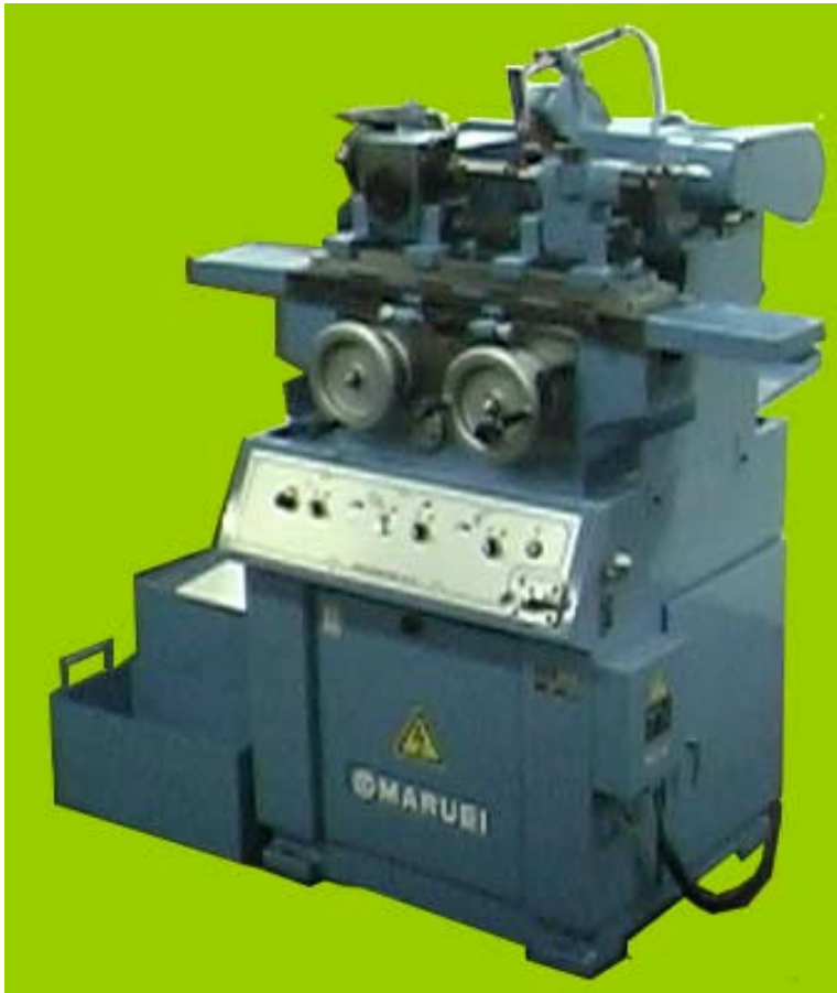
小型精密カム研削盤 CG-100型
